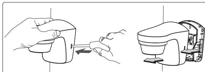
► Benytt skrutrekkeren til forsiktig å løsne på låsekroken på siden og trekk så apparatet ut forover.
