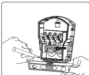
► Lag markeringer forhullene på veggen (med vedlagt boresjablon/ sokkel).
