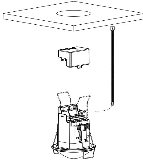
Montering i hule tak for en tykkelse på 0,5 mm til 3 cm. Diameter til utskjæringen i taket må være mellom 62 mm og 70 mm. Kabeltrekkavlasteren blir utført med kabelstrips (bredde 3,5 – 4,8 mm). Melderen må ha fri sikt til personer. Monteringshøyden skal ikke underskride 1,7 m og ikke være høyere enn 4 m.
