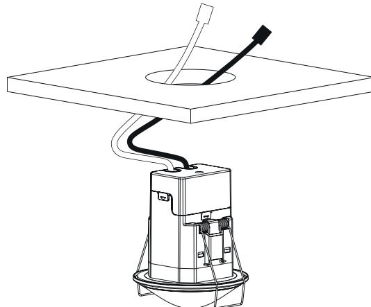
Montering i hule tak for en tykkelse på 0,5 mm til 3 cm. Diameteren til utskjæringen i taket må være mellom 62 mm og 70 mm.
