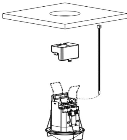
Montering i hule tak for en tykkelse på 0,5 mm til 3 cm. Diameteren til utskjæringen i taket må være mellom 62 mm og 70 mm. Kabeltrekkavlastningen utføres med kabelstrips (bredde 3,5 mm til 4,8 mm). Melderen må ha fri sikt til personer. Monteringshøyden må ikke overskride 1,7 m, og må ikke være høyere enn 4 m.
